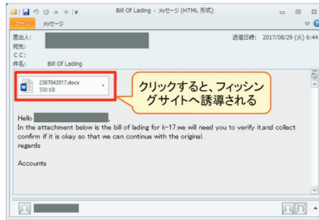
図 4 Word 文書ファイル風のアイコンを使ったフィッシングメール
