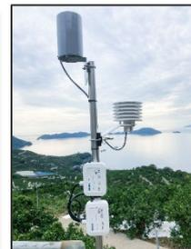
露地栽培 土壌モニタリング + 気象センサー
