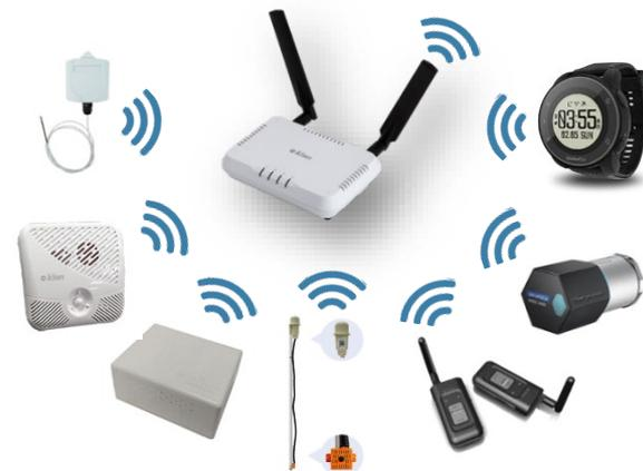
LoRaWAN®はスター型のネットワークトポロジーで構成されます。1つのゲートウェイに対して、多数のセンサーデバイスが接続可能です。センサー個別ではなく、ゲートウェイが集約してインターネット接続を行うことによって**通信費用のコストを削減**します。
